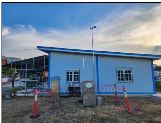
รูปที่ 3.7 การเก็บตัวอย่างคุณภาพอากาศในบรรยากาศ บริเวณบ้านบ่อหิน
