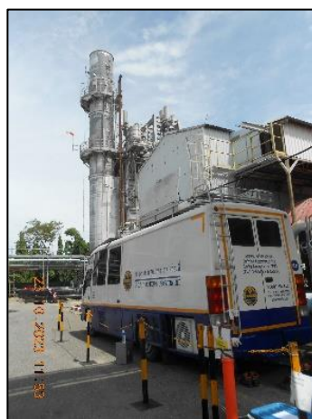
รูปที่ 3.2 การเก็บตัวอย่างคุณภาพอากาศจากแหล่งกำเนิด บริเวณปล่อง HRSG#2
