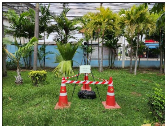
รูปที่ 3.12 การตรวจวัดระดับเสียงในบรรยากาศเฉลี่ย 24 ชม. ( L_{eq} 24 hr.) และ L_{90} บริเวณบ้านไร่หนึ่ง
