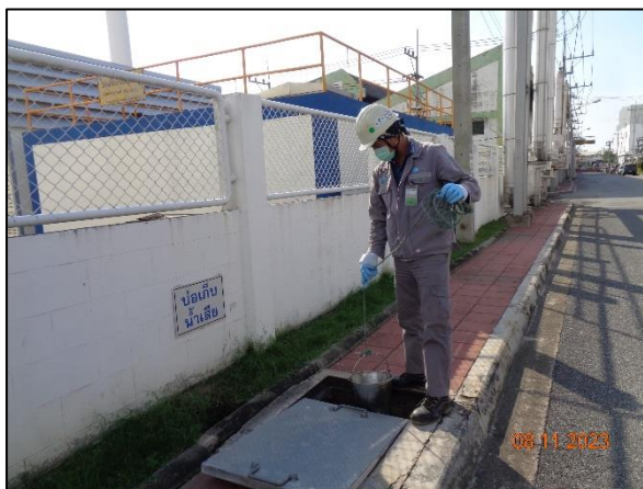
รูปที่ 3.9 การเก็บตัวอย่างน้ำ บริเวณจุดปล่อยน้ำทิ้งจุดที่ 1 จากโครงการเข้าสู่ระบบรวบรวมน้ำเสียของสวนอุตสาหกรรมเครือสหพัฒน์-ศรีราชา
